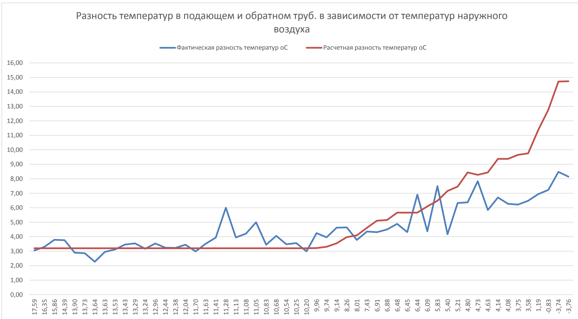
Рисунок 10. Сравнение фактической и расчетной разницы температур по суточным отчетам УУТЭ
