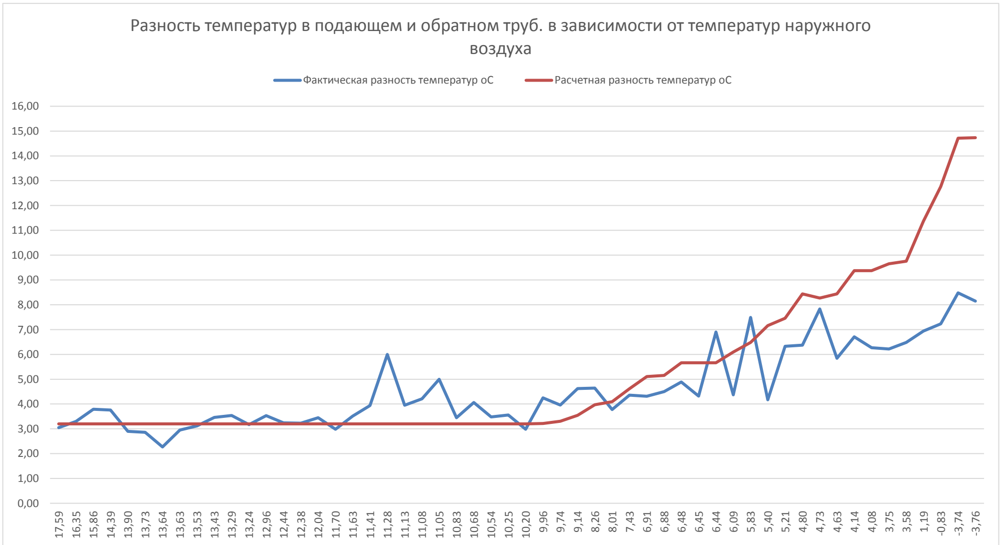
Рисунок 11. Сравнение фактической и расчетной разницы температур по суточным отчетам УУТЭ
