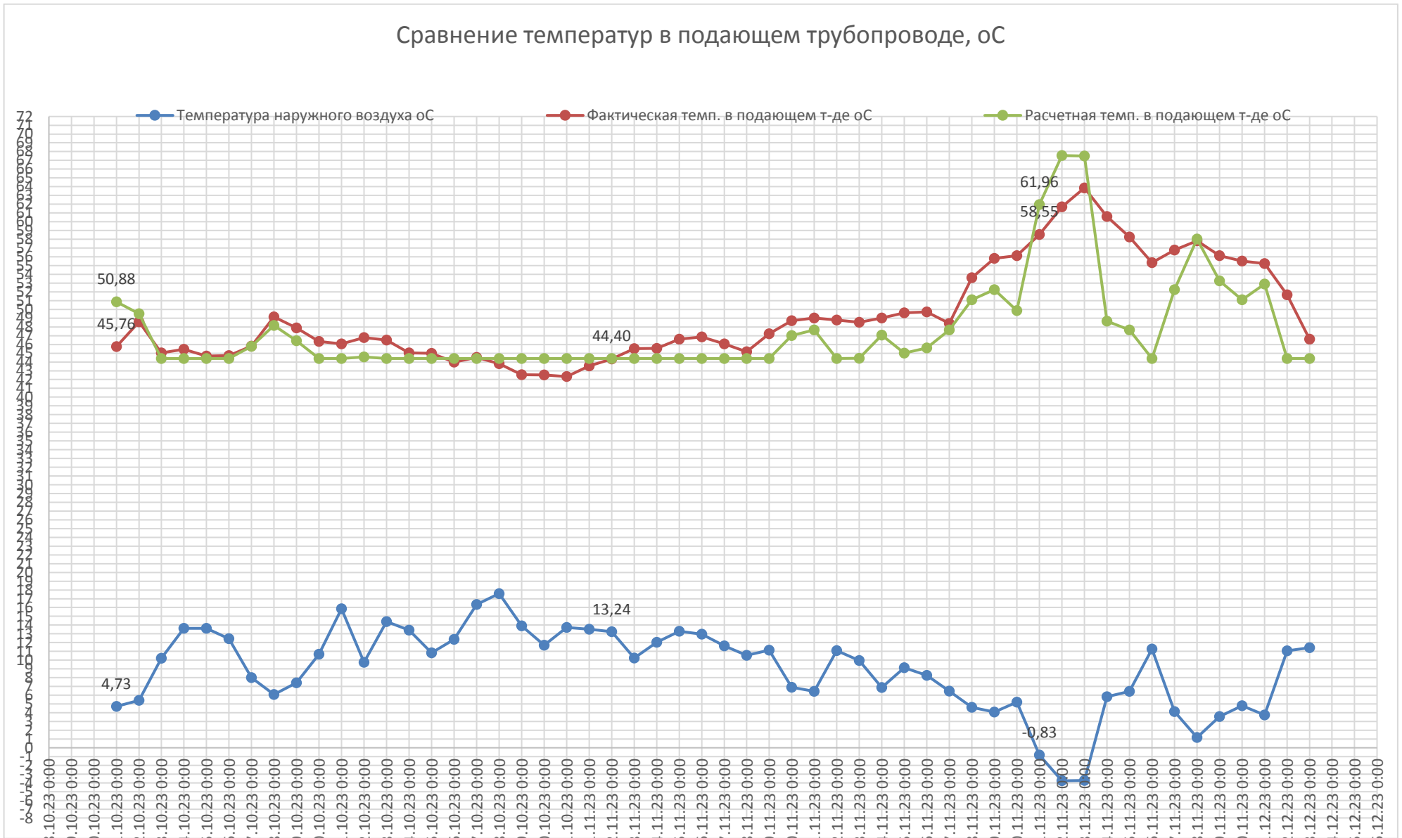
Рисунок 9. Сравнение фактических параметров теплоснабжения с расчетными по суточным отчетам УУТЭ в подающем трубопроводе
